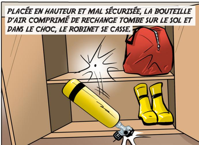
PLACÉE EN HAUTEUR ET MAL SÉCURISÉE, LA BOUTEILLE D'AIR COMPRIMÉ DE RECHANGE TOMBE SUR LE SOL ET DANS LE CHOC, LE ROBINET SE CASSE.
