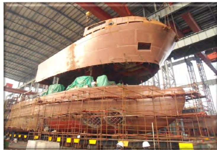
Chantier Zhejiang : assemblage de modules du premier Bourbon Liberty 150
